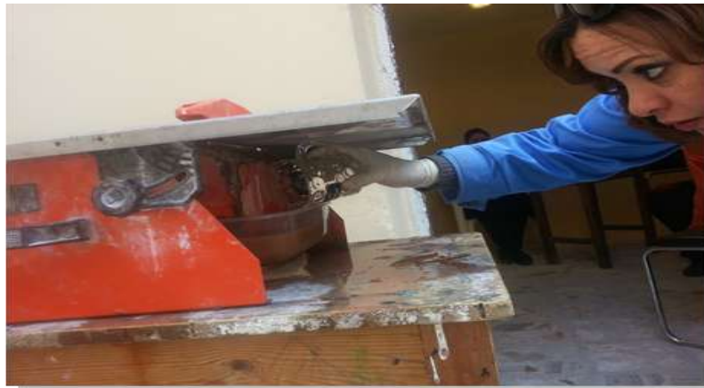
شكل (٢٢) اثناء تزويد الماكينة بالماء للعمل على تبريد الفدية ولعامل الامان
