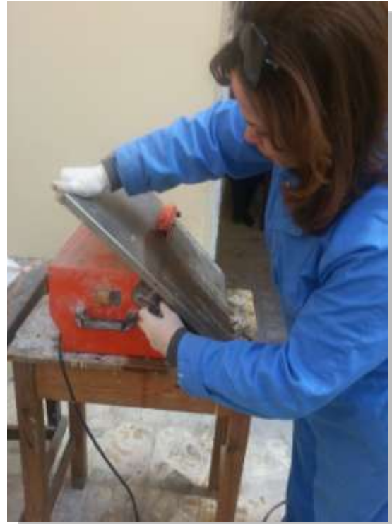
شكل (١٨) اثناء ضبط وضعية ماكينة التقطيع على زاويه ٥٠ درجة
